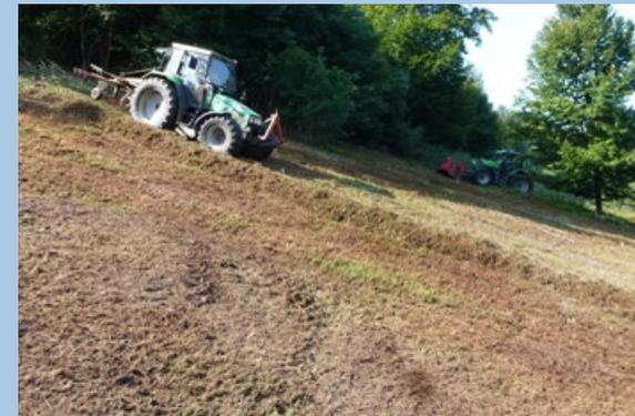
Mulchmäh mit einem Standard-Landwirtschaftsmulcher mit Y-Messern. Dieser ist leichter als ein Forstmulcher und reißt zudem den Wurzelfilz besser auf. Standard-Einkreiselschwader im Vordergrund.
