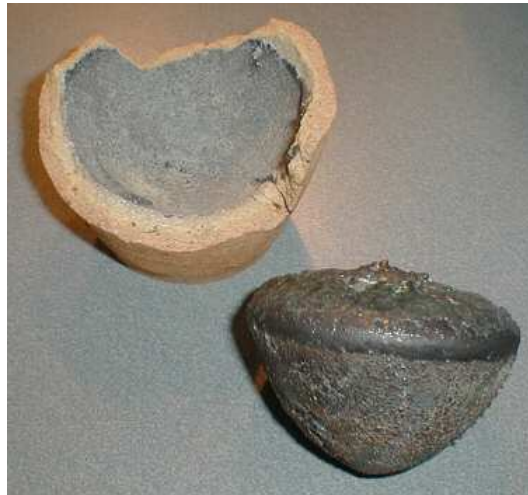
Abb. 4: Wootzkönig ( regulus ) mit Tiegel 29
