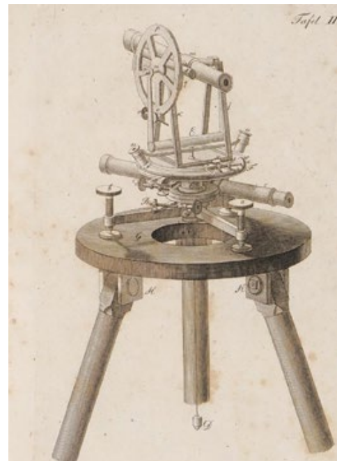
Abb. 8 und 9: Repetitionstheodolit von Rößler (aus [1] Eckhardt 1813 Tafeln I und II). Abb. 9 (rechts) zeigt den Theodolit ohne Repetitionseinrichtung am Vertikalkreis.
