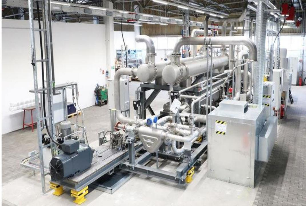
**Quelle DLR Stuttgart:** Weltrekord  $20^{\circ}\text{C} \rightarrow 300^{\circ}\text{C}$  bei 200 kW Wärmeleistung.
