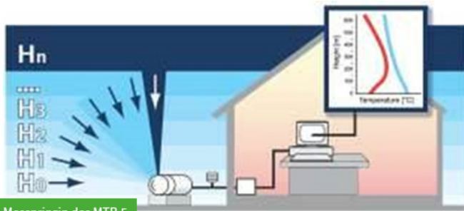
Abbildung 1 - Messprinzip des MTP-5
