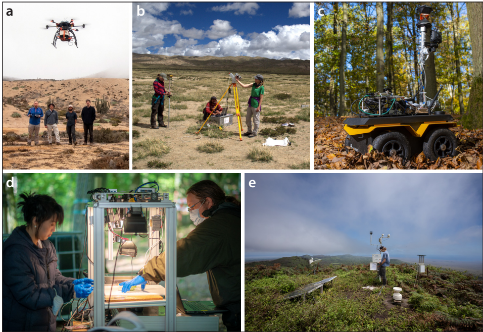
Abb. 5: Ausgewählte Einblicke in die LCRS Feldforschung. (a) Laserbasierte Vermessung von Profilen des Tropfenspektrums im Nebel der chilenischen Atacama (SPP Earthsape), (b) Vermessung der Vegetationsdegradation auf dem Tibet Plateau (BMBF PADEMOS), (c) Rover-basierte Messung von mikroklimatischen Eigenschaften im Marburger Universitätswald (LOEWE Natur 4.0), (d) hochauflösende hyperspektrale Scans von Eichenblättern (LOEWE TreeM), (e) Niederschlagsmessungen in Galapagos (DFG-Projekt DARWIN). (Fotos: (a+e) © J. Bendix, (b) © L. Lehnert, (c+d) © M. Dobbermann)
