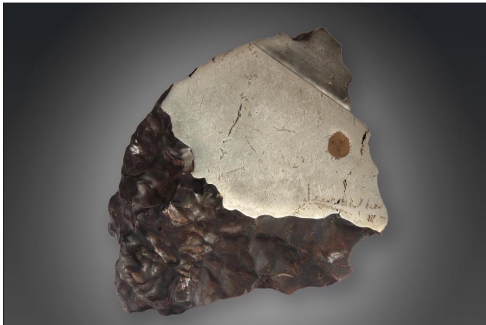
Abb. 7: Meteorit von Treysa mit anpolierter und angeätzter Oberfläche (Foto: A. Weisbrod)
