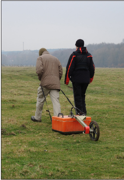
Abb. 2: Messungen mit dem Georadar (Foto: © T. Kasielke)
