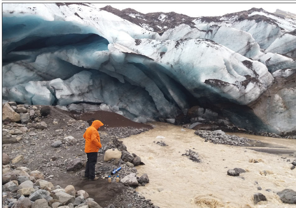
Abb. 5 und 6: Messung verschiedener hydrochemischer und -physikalischer Parameter mit einer Multiparametersonde (EXO2, YSI Inc.) am Fláajökull (oben) und am Gletschertor des Falljökull (unten) (Fotos: © M. Reiss (oben), © P. Chiffard (unten))
