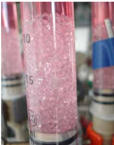
Produktion von Stammzellen auf Carriern im Einweg-Festbettreaktor für den therapeutischen Einsatz
