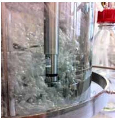
Entwicklung von Sonden zur PAT-konformen Online-Messung der Biolebensmasse
