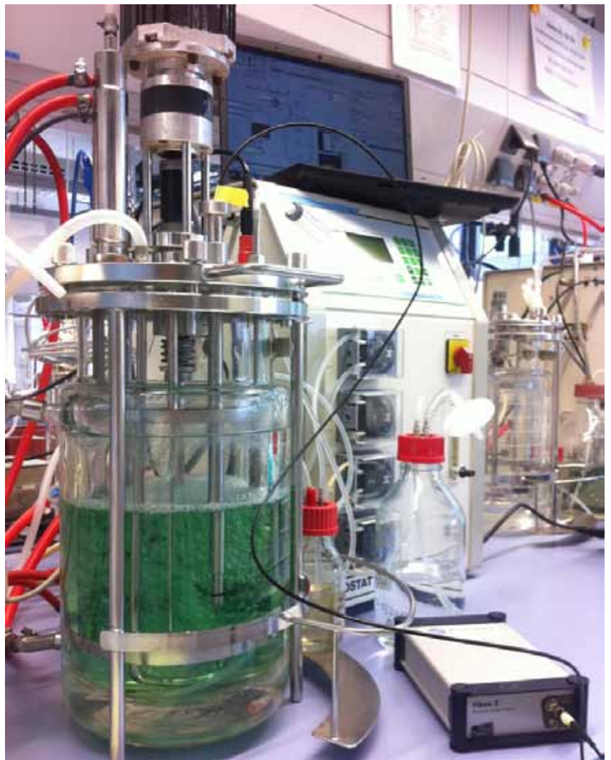
Integration der Sensorik zur Prozesssteuerung und -automatisierung
