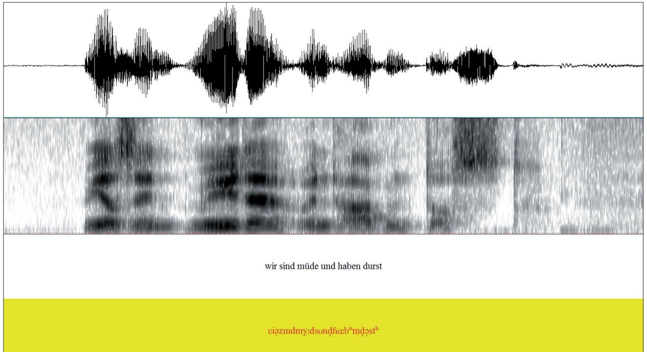
Gesprochene Sprache als Basis der Untersuchungen: Oszillogramm und Spektrogramm eines Sprachsignals
