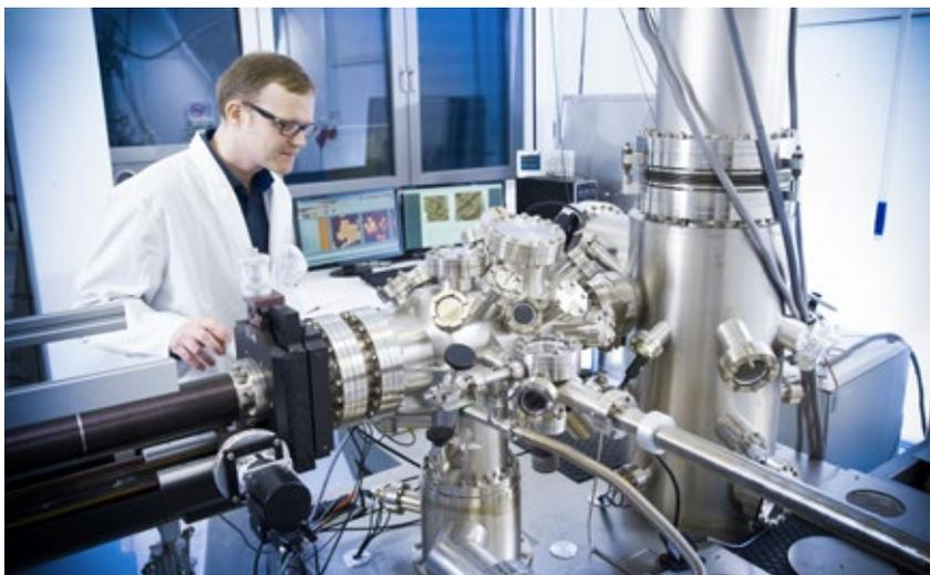
Messung einer Elektrodenoberfläche mit atomarer Auflösung in ionischer Flüssigkeit (2015).
