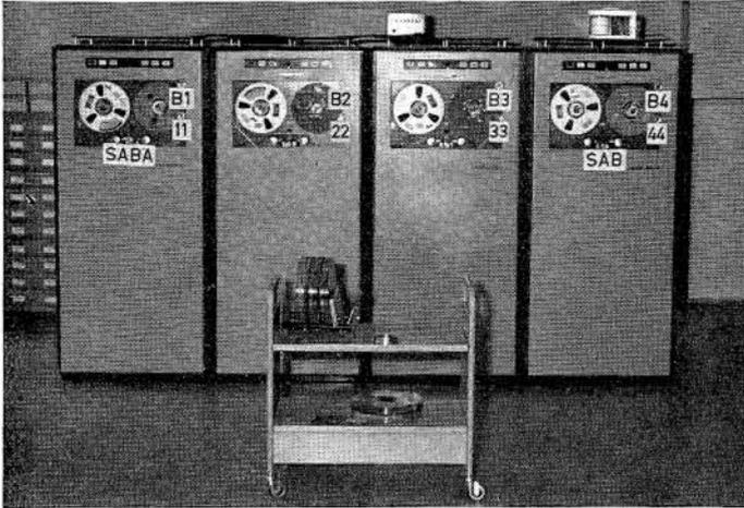
Abb. 2: Die vier Magnetbandgeräte dienen zur Zwischenspeicherung von Informationen.
