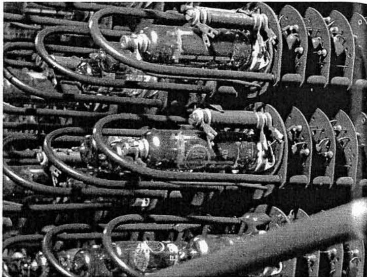
Das Rechenwerk der Z22 besteht aus rund 400 Röhren.
