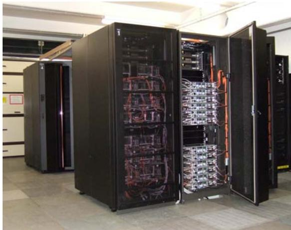
Als Shared Memory Rechner (SMP) sind die Maschinen besonders gut für parallele Probleme mit hohem Kommunikationsbedarf geeignet. Um auch Programme, die mehr als einen SMP-Knoten benötigen, effektiv verarbeiten zu können, sind die Rechner untereinander mit einem schnellen internen Netzwerk verbunden (IBM High Performance Switch (HPS)).
