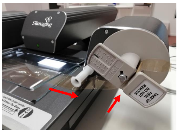
Film unter der oberen Glasscheibe durchziehen und wie in der Abb. an der rechten Spule fixieren
