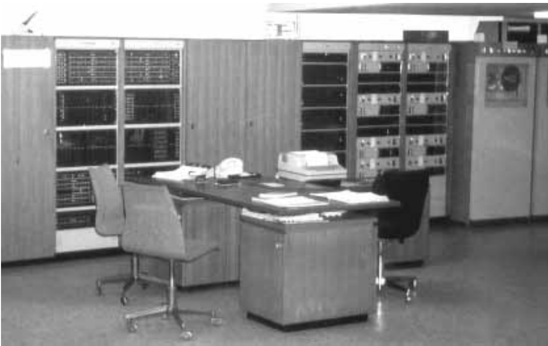
Die ersten Rechner hatten noch die Ausmaße von Schrankwänden: TR4 (1966–1975). Die beiden dunklen Schränke links bildeten die Zentraleinheit.
