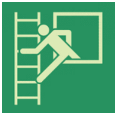
Notausstieg mit Fluchtleiter in Fluchtrichtung
