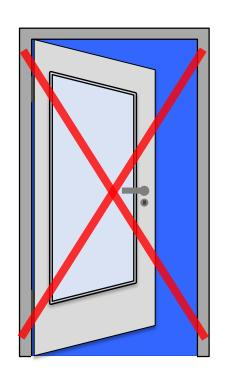
Bei technisch be- und entlüfteten Laboren müssen die Labortüren und Fenster grundsätzlich geschlossen werden!
