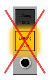
Bevor Arbeiten mit Gefahrstoffen im Abzug oder im Laborbereich aufgenommen werden, muss die Lüftung am Laboreingang auf 100% geschaltet werden (grüne Signallampe leuchtet)!
