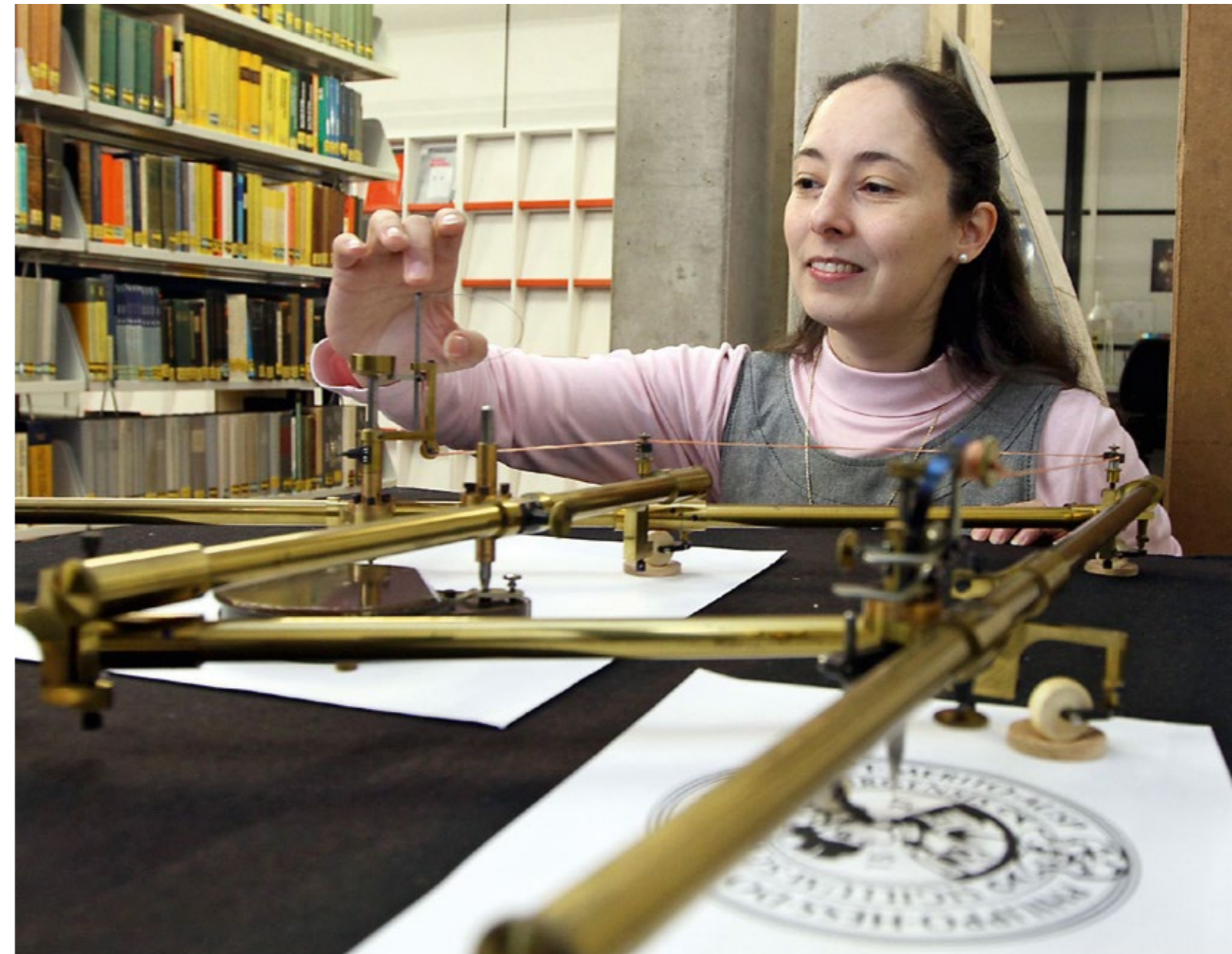
▲ Die Mathematik-Professorin Ilka Agricola bedient einen Pantographen, mit dessen Hilfe man Zeichnungen oder Landkarten vergrößern oder verkleinern kann.
