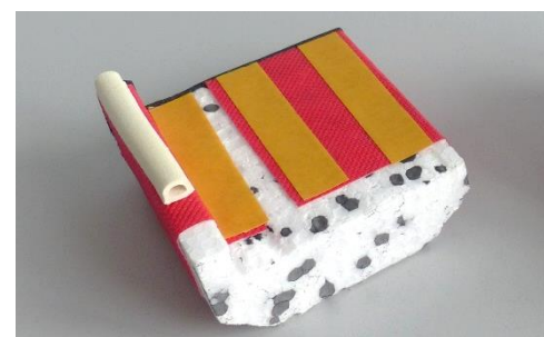
Abbildung 3: Musterstück aus EPS mit rotem Gewebeklebeband, doppelseitigem Klebeband und selbstklebender Fensterdichtung.
