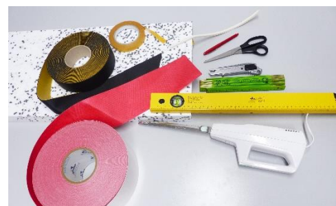
Abbildung 2: Du brauchst Dämmung, doppelseitiges Klebeband, Kautschukklebeband, extrabreites Gewebeklebeband und Fensterdichtung. Metermaßstab, Messer, Schere, Stift, einen langen, graden Gegenstand und ein Elektromesser oder Styroporschneider.
