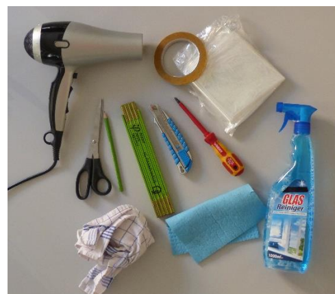
Abbildung 2: Du brauchst: Die Fensterfolie mit dem doppelseitigen Klebeband. Handtuch, Lappen und Reinigungsmittel. Schraubendreher, Messer, Schere, Metermaßstab und Stift. Außerdem: einen Haarföhn.
