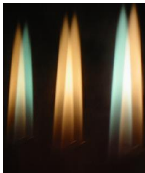
Abbildung 2: Die Flamme eines Feuerzeugs spiegelt sich in einer 3-fach Verglasung. Die äußere Seite der inneren Verglasung und die innere Seite der äußeren Verglasungen sind beschichtet: Hier ist die Spiegelung verfärbt.
